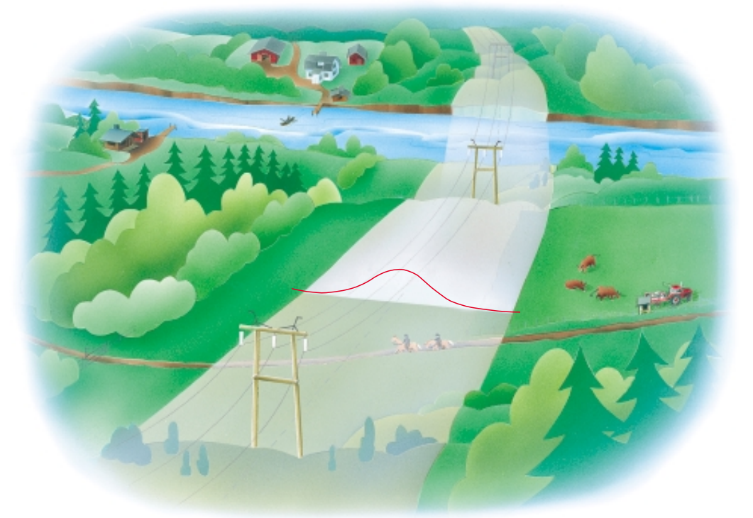
Röd kurvan beskriver det genomsnittliga magnetfältets dämpning.
